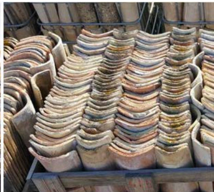
Stockage sur la tranche
