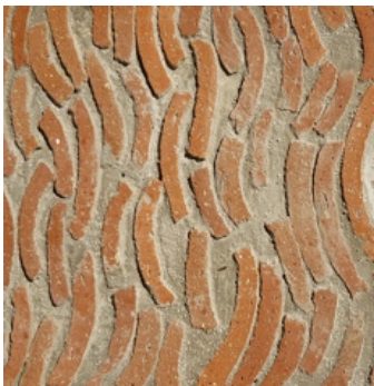
Exemple : Dalle préfabriquée tuile / béton
